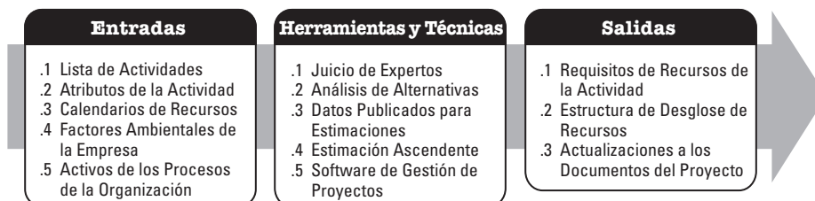
Gráfico 6-8. Estimar los Recursos de las Actividades: Entradas, Herramientas y Técnicas, y Salidas
